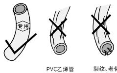
2、胶管的一端套入灶具进气接头至红线处，连接处用卡箍箍紧，防止漏气，另一端接气源总阀胶管不要置于灶面上，且胶管不得受压、硬性折弯等。
