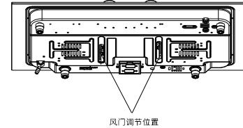
• 握住风门调节手柄，抬起1mm左右后再向左或右拨动。手柄向左拨动时，调小风门进风口，空气进入量减少，火焰呈黄色转变；手柄向右拨动时，调大风门进风口，空气进入量增大，火焰呈蓝色转变。
